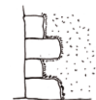
Technique traditionnelle : l'enduit plein à la chaux vient mourir au nu de la pierre. Rien ne fait saillie.
