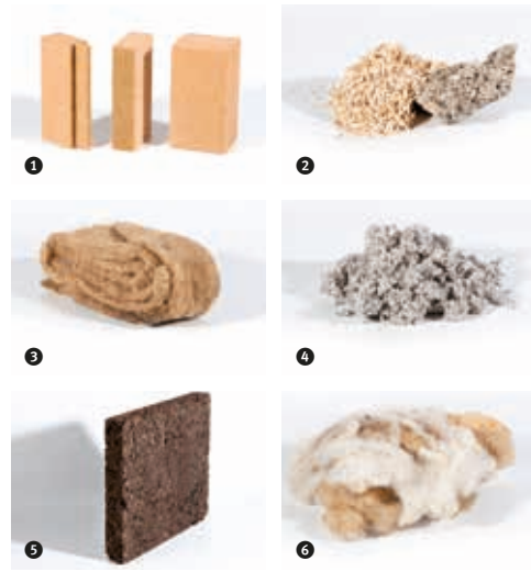
1 Laine de bois, 2 mortier chaux et chanvre et chenevotte, 3 laine de chanvre en rouleau, 4 ouate de cellulose, 5 panneau de liège, 6 laine de mouton. Ces matériaux sont visibles dans la matériauthèque du CAUE/ exposition permanente.
